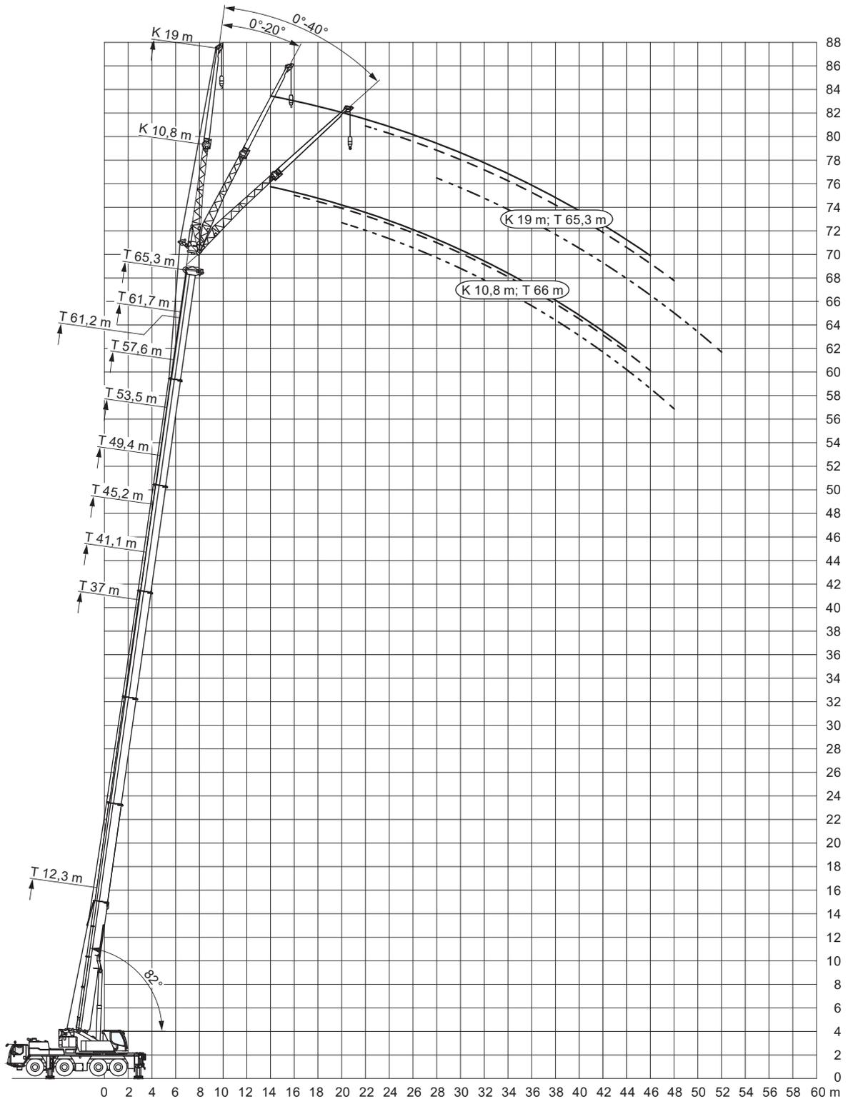
■ Unter Last hydraulisch wippbar
